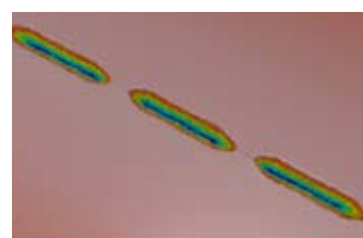
齿形3D切割齿痕
